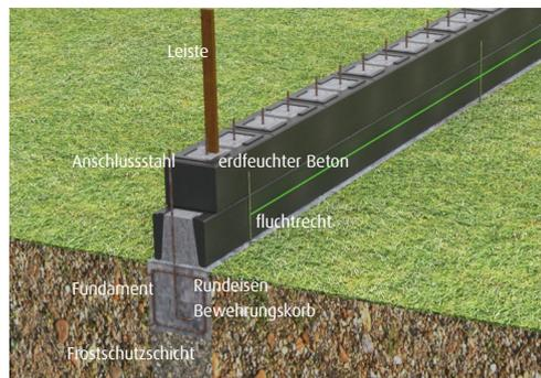
Die Mauersteine werden lagenweise mit erdfeuchtem Beton (präferiert auf Trasszement-Basis) verfüllt und mit einer geeig-neten Leiste verdichtet.
