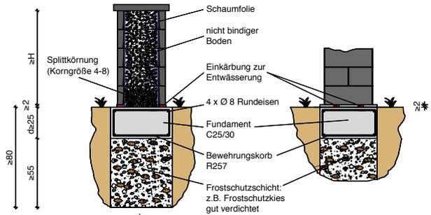
Nichtbindiger Boden ist ein Boden mit einem geringen Anteil an Feinkorn. Zu dieser Bodenart zählen Sand und Kies in verschiedenen Korngrößen und Mischungen. Bei der Verdichtung von nichtbindigen Böden wie bei Sanden und Kiesen werden die Körner in eine dichtere Packung umgelagert, wobei kleinere Körner die Poren zwischen größeren Körnern ausfüllen.
