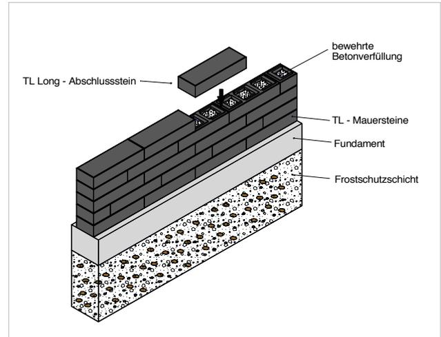
Die Mauersteine werden lagenweise mit erdfuchtem Beton (präferiert auf Trasszement-Basis) verfüllt und mit einer geeigneten Leiste verdichtet. Der Beton der oberen Schicht wird leicht erhöht eingebracht und danach die Abschlusssteine aufgesetzt.
