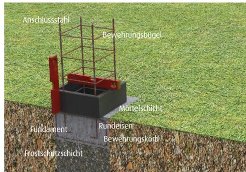
Die erste Schicht der Elemente muss absolut fluchtrecht und waagrecht in eine Zementmörtelschicht verlegt werden (hiernach ist eine Ruhepause ratsam).
