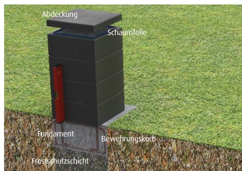
Der Beton der oberen Schicht wird leicht erhöht dachförmig eingebracht und danach die Pfeilerabdeckung aufgesetzt. Der Füllmengenbedarf kann separat angefordert werden.
