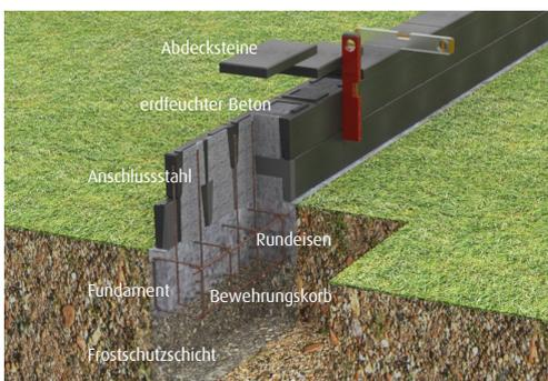
Den Beton der oberen Schicht wird leicht erhöht eingebracht und danach die Abdecksteine aufgesetzt. Die Stoßfugen der Abdeckungen sind mit einem geeigneten dauerelastischen Fugenmaterial (z. B. auf Polyurethanbasis) gegen eindrin-gendes Wasser zu verschließen.
