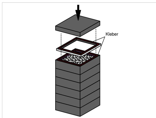
Der Edelstahlrahmen wird auf das oberste Pfeiler- und Bewehrungselement platziert und kann verklebt werden. Danach wird die Pfeilerabdeckung aufgesetzt.
