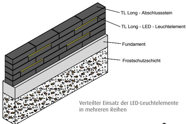
Verteilter Einsatz der LED-Leuchtelemente in mehreren Reihen
