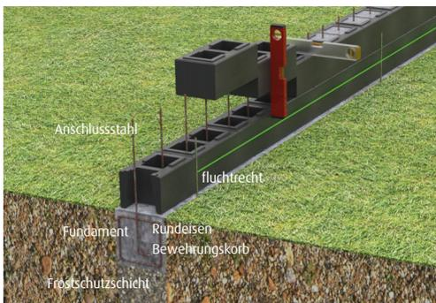
Beim lagenweisen Aufsetzen der weiteren Mauersteine ist ein lotrechter sowie auch weiterhin ein fluchtrechter und waag-rechter Aufbau zu beachten. Evtl. fertigungsbedingte Maß-toleranzen sind auszugleichen (z. B. von der Innenseite mit einem Fliesenkeil).
