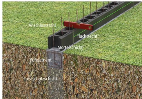
Die erste Schicht der Mauersteine muss absolut fluchtrecht und waagrecht in eine Zementmörtelschicht verlegt werden (hier-nach ist eine Ruhepause ratsam).
